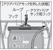
アクアバリアサックの本 体接続ベルクロとフック を外します。トレールウォ ーターパックのスライドパ ーツのフックを荷室内上 部の図のループに掛け て装着し、図の通し穴か らバックパックの外にチ ューブを出します。左右 の通し穴のどちらからで も出すことができます。
