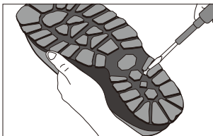
▲詰まった石を取り除く
