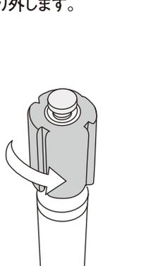
④ 本製品の新しいストッパーを矢印のように時計回りに回し、取り付けます。
