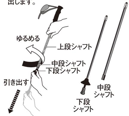
② 中段シャフトと下段シャフトから古い脱落防止用パーツ(ワッシャー)を取り外します。
