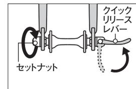
②クイックリリースレバーを半分ぐらい閉じた位置で固くなるようセットナットを時計回りに締めて調整します。
