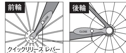
⑤前輪のクイックリリースレバーは前フォークと平行に、後輪のクイックリリースレバーは進行方向へ倒してください。
