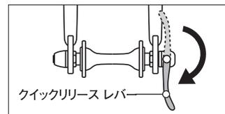
①ハブのクイックリリースレバーをOPENの刻印が見える位置へ倒します。
